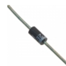
3EZ5.6D5E3/TR12 Microsemi Corporation DIODE ZENER 5.6V 3W DO204AL
